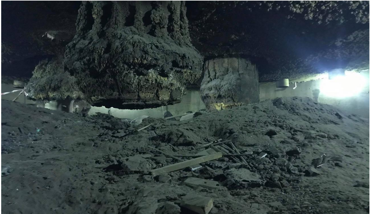
Foto .5. Pamja e elektrodave skenderberg në furrën elektrike
