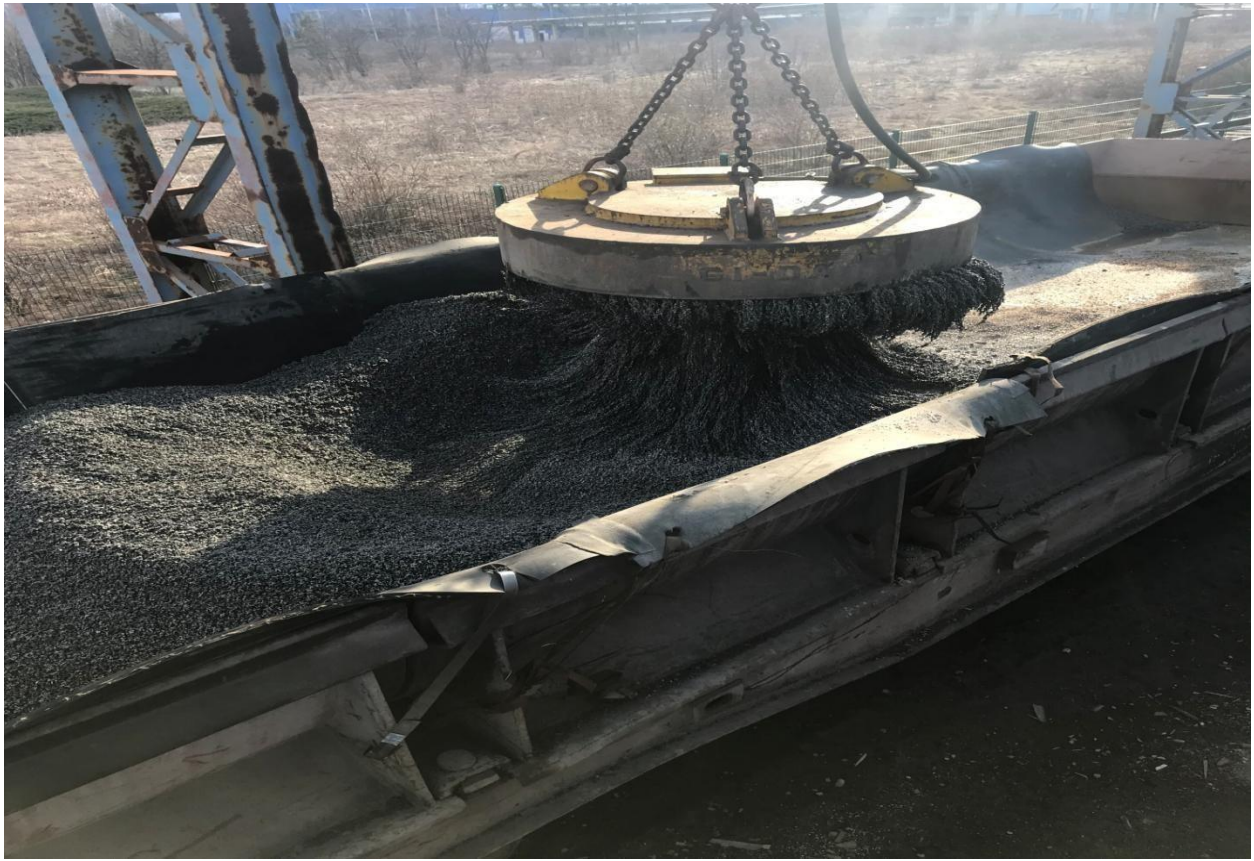
Foto .12. Ngarkimi i ferronikelit me elektro-magnet dhe vendosja ne hikë
