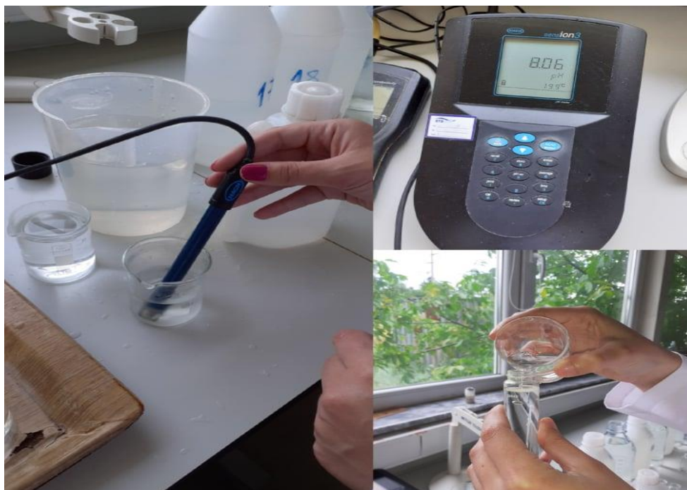
Figura 3.2: Procedura e punës së përcaktimit të pH-së
