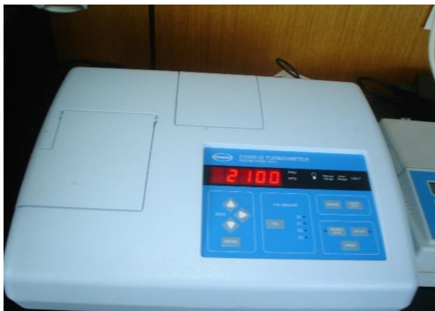
Figura 3.8 Instrumenti për përcaktimin e turbullirës së ujit (Turbidimetri)
