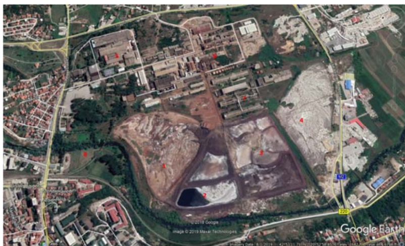
Figura 2.4: Pamje e deponisë dhe PIM (1-fundërresa EIMCO; 2-pirit dhe pirotinë; 3-jarosit; 4- fosfogjips; 5-Industria e Baterive; 6-Metalurgjia e Zinkut; 7-Industria Kimike; 8-Lumi Shtënicë)
