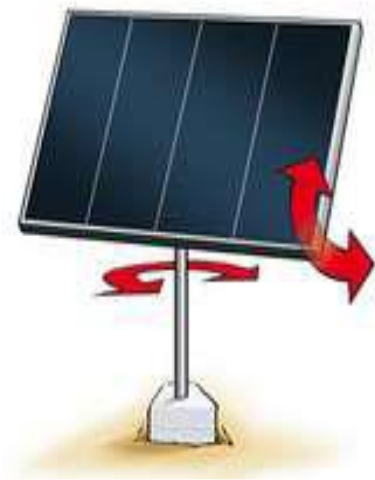
Figura 21. Pamje e panelit solar ndjekës i rrezeve [21].
