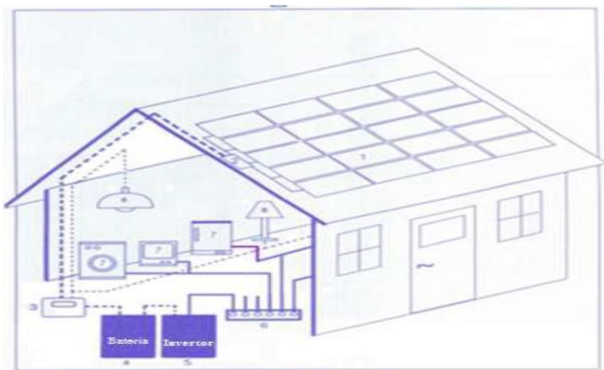
Figura 23. Skicia e lidhjes së sistemeve diellore të pavarura nga rrjeti elektrik [23].
