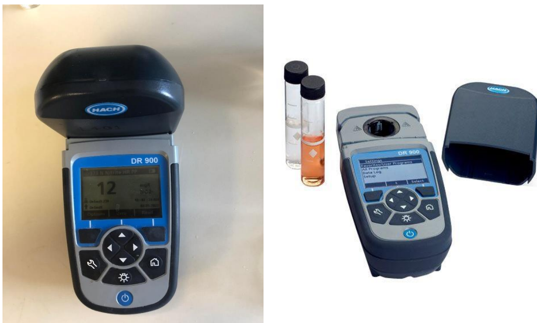
Figura 3.9: Fotometri për përcaktimin e nitriteve dhe nitrateve.
