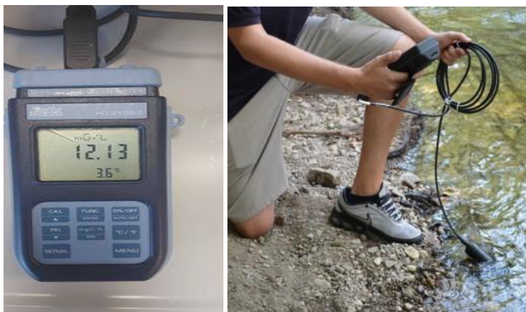
Figura 3.4: Përcaktimi i oksigjenit të tretur në trupin ujqor me pajisjen Delta OHM.
