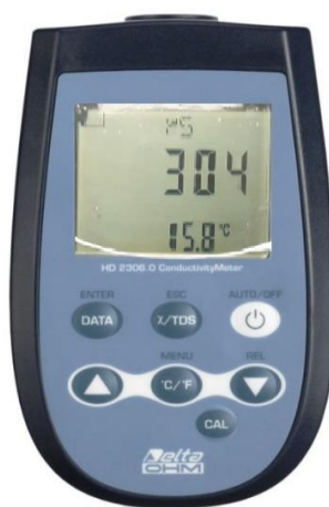
Figura 6: Pajisja digjitale Delta OHM 2306.0 për matjen e përçueshmërisë elektrike e përdorur në laboratorin e fakultetit të FTU-së
