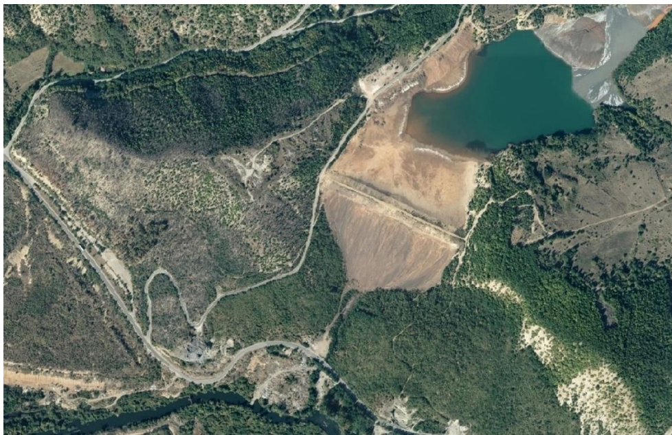
Figura 2.6: Akumulimi i ujit acidik në fshatin Kelmend, Komuna e Mitrovicës, të shkarkuar nga Flotacioni dhe derdhja e tij në lumin Ibër [55].
