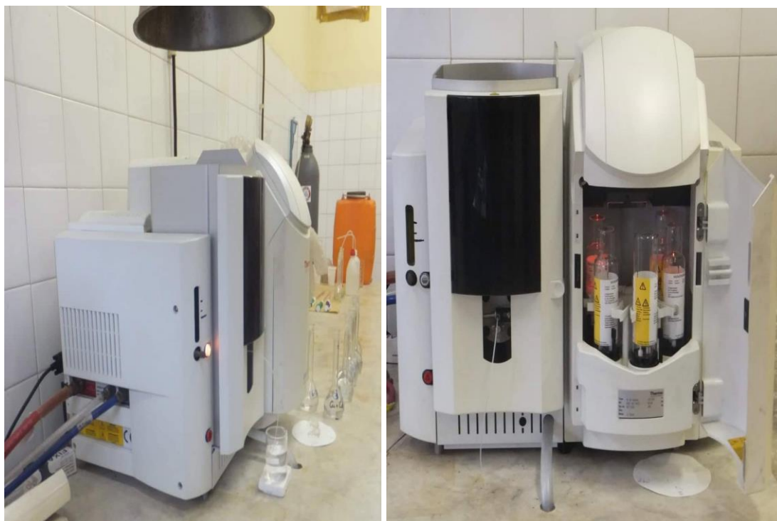
Figura 3.10: Absorberi atomik spektroskopik dhe llampat katodike të vendosura.
