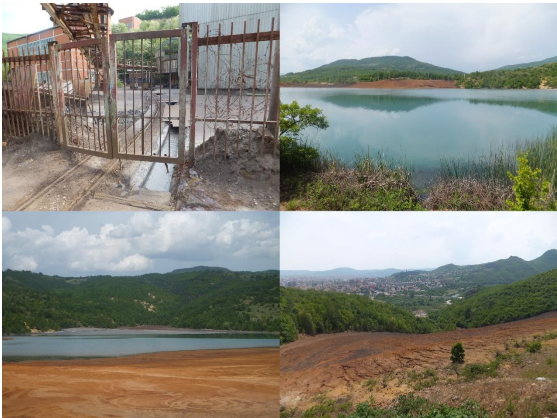
Figura 3: a) Shkarkimi i ujërave acidike nga Flotacioni, b) dhe c) Akumulimi i këtyre ujërave në fshatin Kelmend dhe d) Derdhja e tyre në lumin Ibër
