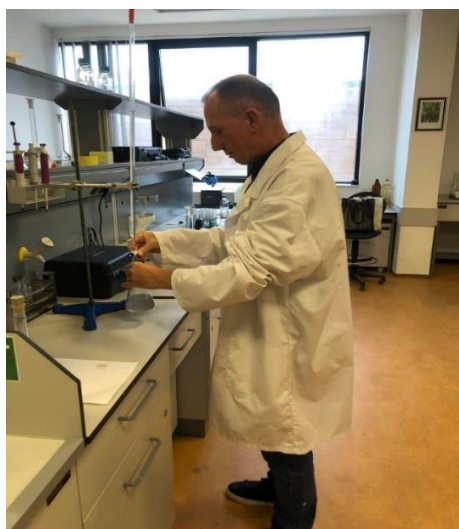
Figura 7: Titrime i mostrës së ujit në biretë gjatë përcaktimit të fortësisë së ujit
