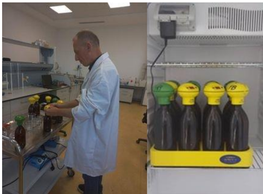
Figura 3.8: Përcaktimi i kërkesës biokimike të oksigjenit.
