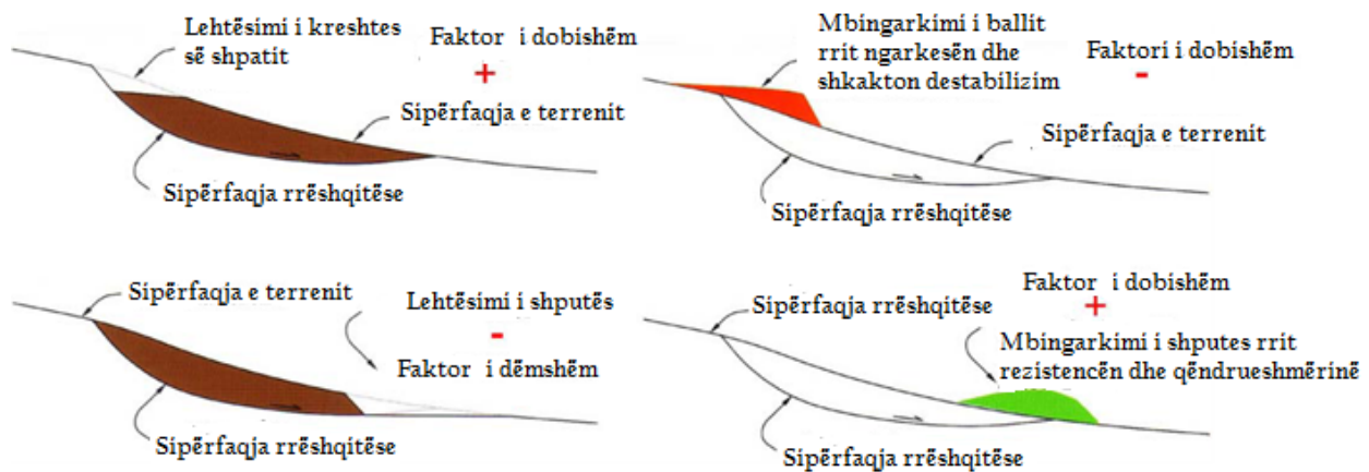
Figura 2.2. Efektet e ndryshimit të ngarkesës ose lehtësimit në shpate
