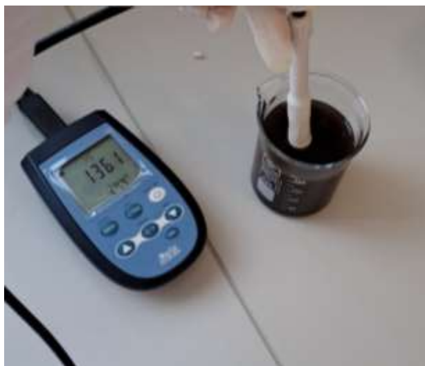
Figura 3.7: Përcaktimi i përcjellshmërisë elektrike.
