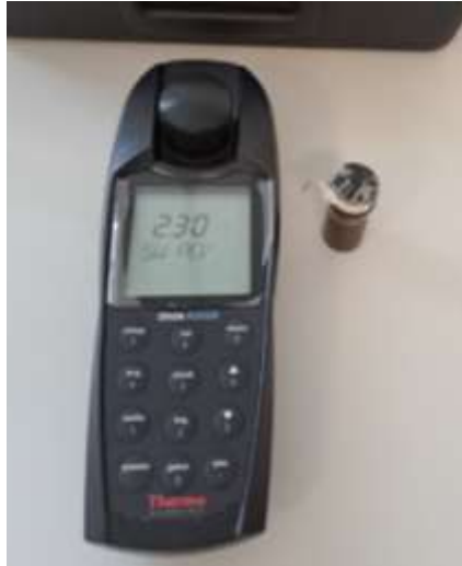
Figura 3.4: Përcaktimi i turbiditetit me anë të turbidimetrit.
