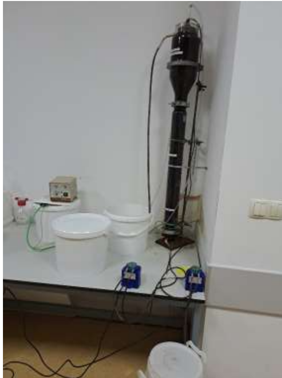
Figura 3.1: Reaktori UASB duke trajtuar ujërat e thertores.
