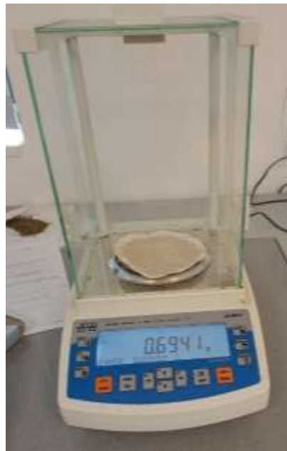
Figura 3.6: Peshimi i filtrit pas tharjes me mostrën e analizuar për përcaktimin e TLNP.
