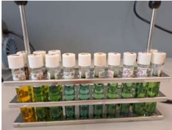
Figura 3.14: Përcaktimi i KKO, dhe ndryshimi i ngjyrave pas trajtimit në reaktor.
