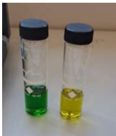
Figura 3.9: Përcaktimi i \text{NH}_3\text{-N} , me shfaqjen e ngjyrës së gjelbër (në anën e majtë, kurse ngjyra e verdhë paraqet mostrën e verbër).
