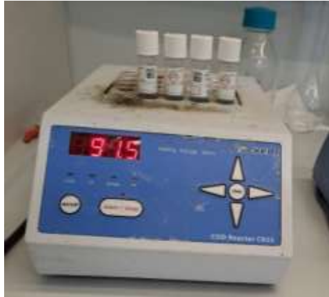
Figura 3.10: Trajtimi me nxehtësi i epruvetave për përcaktimin e AT.
