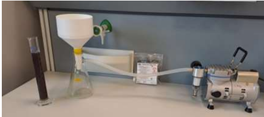
Figura 3.5: Përcaktimi i TLNP me anë të vakuum pompës.
