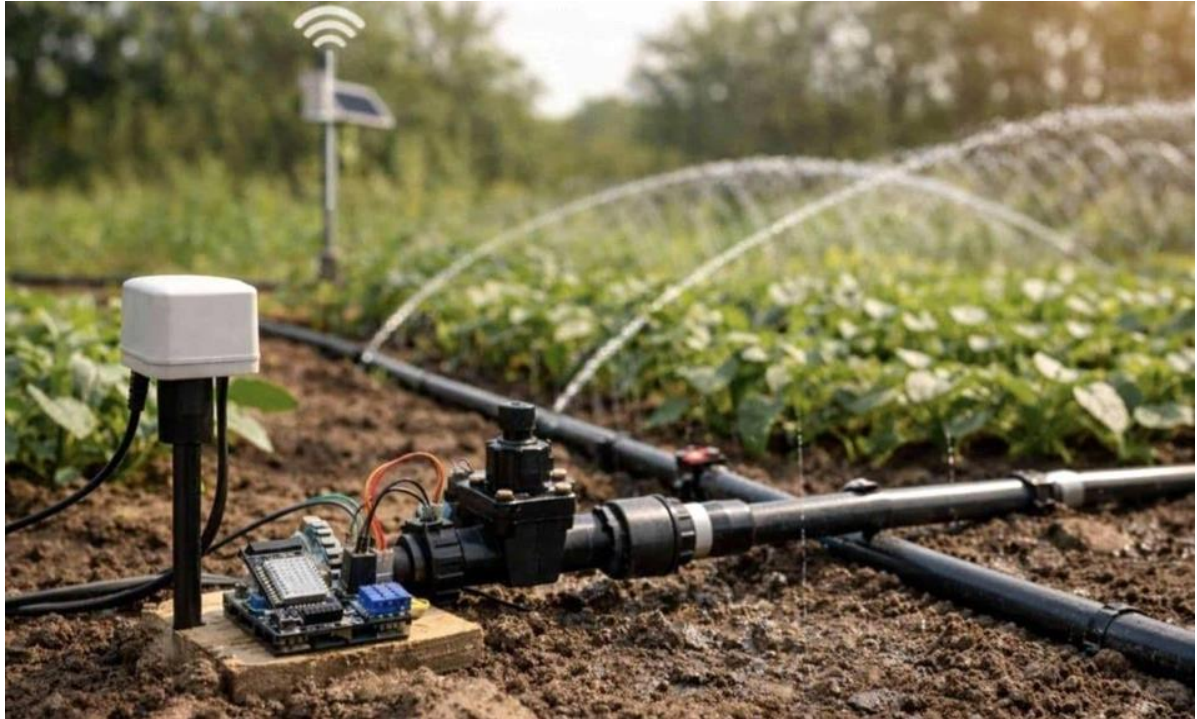
Figura 3.6: Sistemi inteligjent i monitorimit të lagështisë së tokës dhe ujitjes automatike
