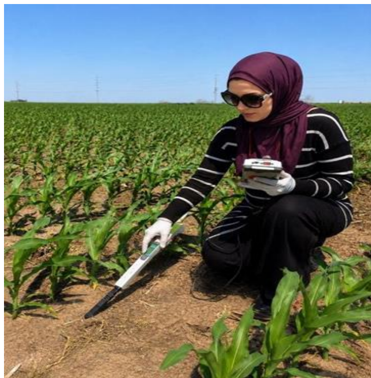
Figura 3.9: Monitorimi i lagështisë së tokës në terren me sensor infra të kuq.
