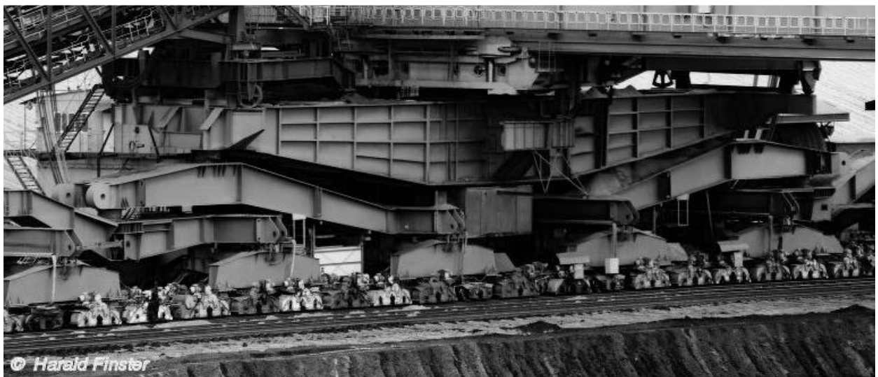
Figura 4.2 Pajisjet transportuese që aplikohen për zhvendosjen e ekskavatorit kovatorë (a) mbi zinxhir dhe (b) mbi shina
