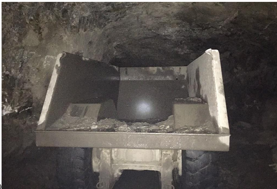
Fig.14. Kamioni i cili përdoret për transportimin e xehes në horizontin e X-të, a) pamja e kamionit nga anash, b) pamja e kamionit nga para dhe c) pamja e kamionit nga prapa(pamja e arkës)
