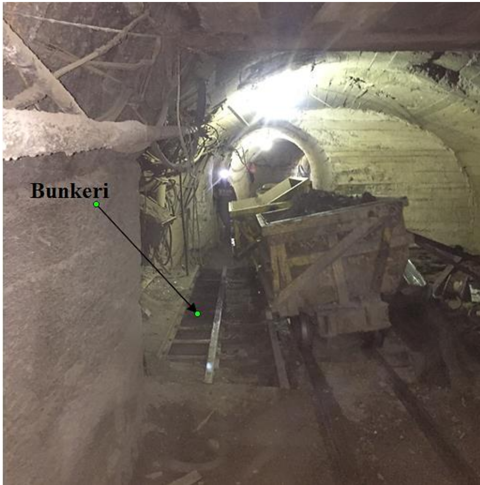
Fig.23. Zbrazja e xehes në bunkerin e horizontit të XI-të të minierës së Stan Tërg-ut
