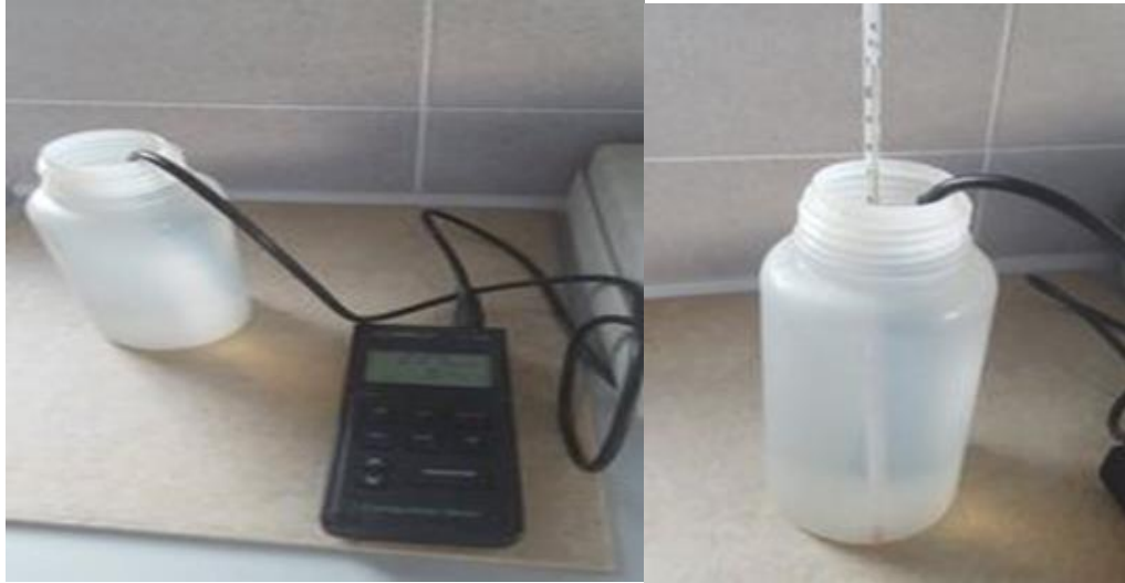
3.3: Përcaktimi i konduktivitetit dhe temperaturës me konduktometër WTW
