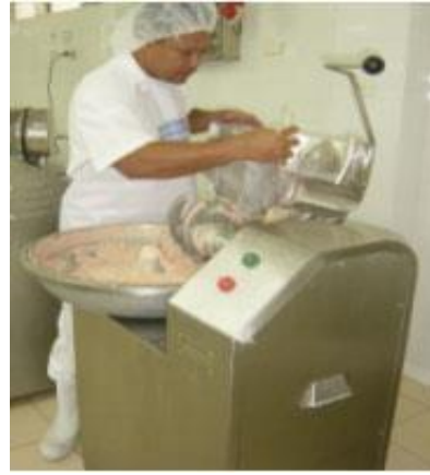
Figura 2.1: Grirja e mishit në grirëse të thjeshtë (majtas) dhe thërrmimi i mishit në grirëse që mbulohet me kapak dhe hapet në përfundim të procesit (djathtas) [2].
