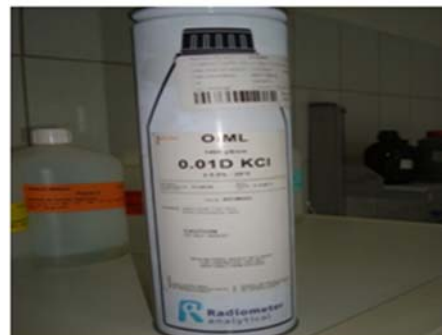
Figura 3.11: TS 1408 \mu\text{S}/\text{cm} në 200 ^{\circ}\text{C} .
