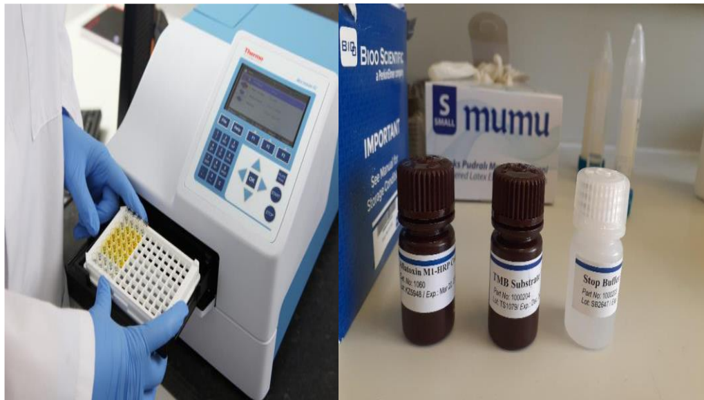
Figura 3.6: Subtrati i aflatoksinës M1 – HRP, substrati TMB dhe Stop Buffer dhe lexuesi i mikropjata
