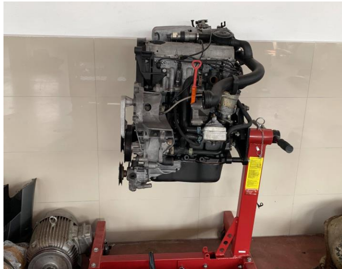
Figura. 3.5 Vinçi për ngritje e motorit dhe mbajtjen në pozicion.
