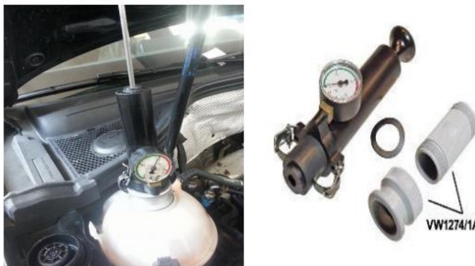
Figura. 3.6 Testuesi i sistemit të ftohjes për ndonjë rrjedhje eventuale VĚ1274/1A.
