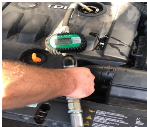
Figura 3.3. Aparatura për mbushje të motorit me vaj.
