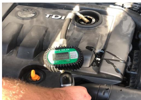
Figura. 4.11 Mbushja e sistemit me vaj të risipaa SAE.
