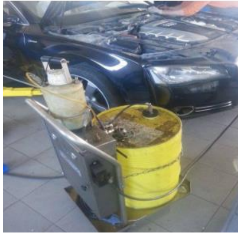
Figura 3.4 Aparatura për mbushje të sistemit të frenimit me vaj.
