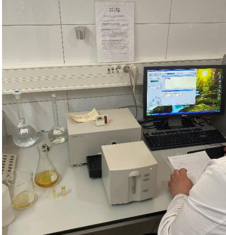
Figura 3.14: Pamje gjatë operimit të analizës me spektrofotometër UV-VIS Aglient 8453.
