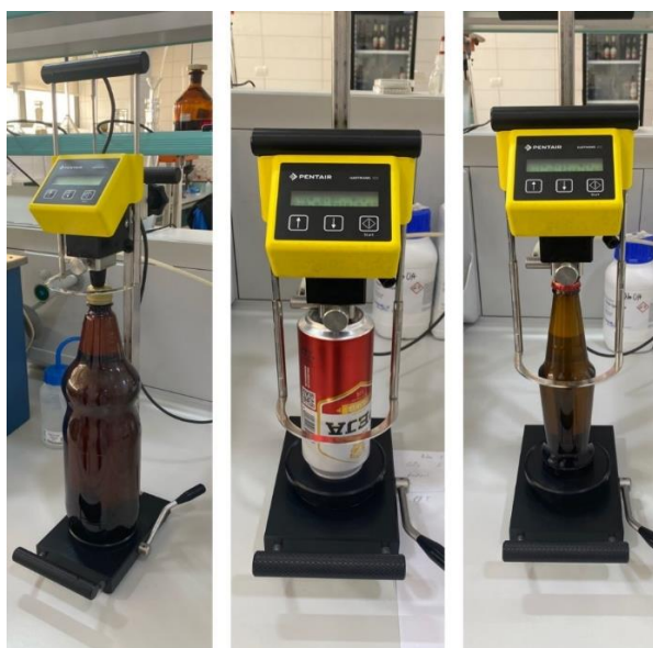
Figura 3.6: Operimi me aparaturën Pentair Haffmans icc, dhe pozita e mostrave për të tri llojet e ambalazhimit të birrës.
