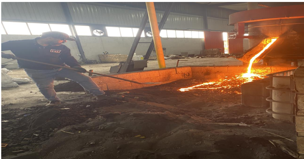
Figura 4: Pamje e rrjedhjes së brancës në “Fondernë E&E” Gjakovë
