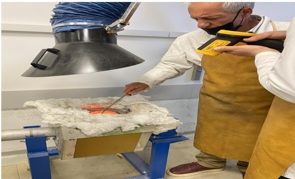
Foto 6: Pamje e matjes se temperaturës së shkrijjes
