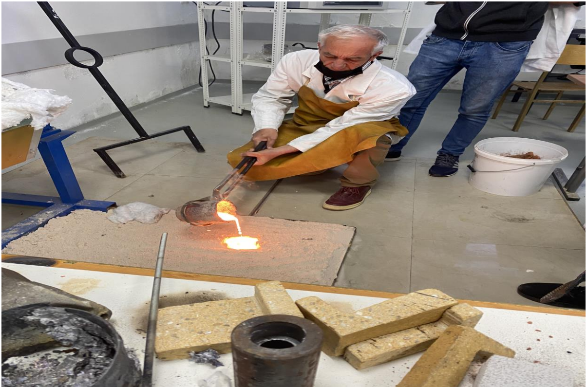
Foto 7: Pamje e derdhjes së mostrës së shkrirë në rërën ku do ngurtësohet
