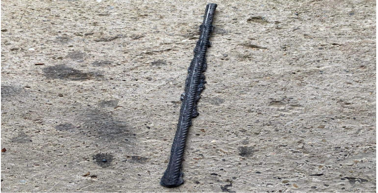
Foto 10: Pamje e mostrës së përgatitur për caktimin e vetive mekanike
