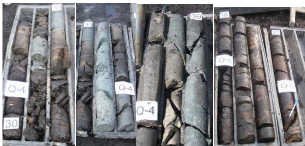
Foto.3.7. Bërthamat e shpimit Q4 dhe karakteristikat tektonike në vendburimn e Sibovcit (Instituti – Inkos).
