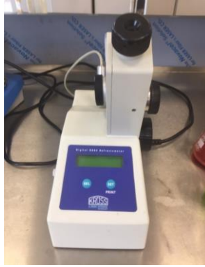
Figura 3.3. Përcaktimi i përmbajtjes së sheqerit-refraktrometri
