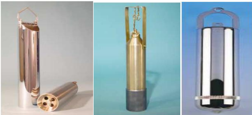
Figura 3.2: Marrësit cilindrik të mostrave për lëngje, lëngje të ndezshme dhe mostra speciale.
