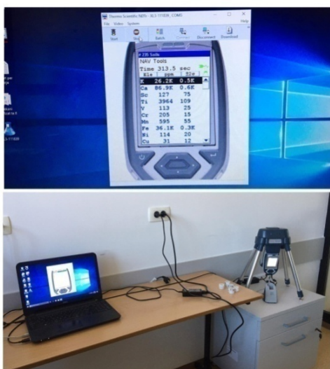
Figura 3.5: Analizimi i dheut me paisjen NITON XL3t..XRF Analyzer.
