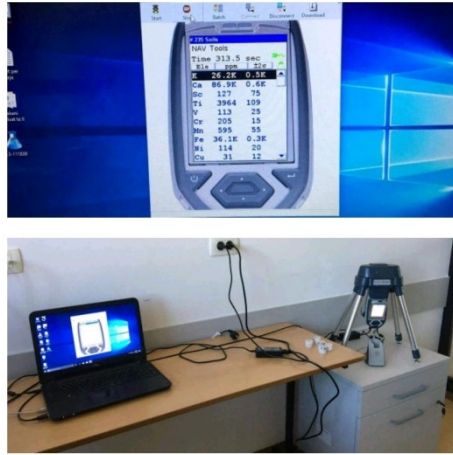
Figura 3. 4: Analizat e dheut me paisjen NITON XL 3T XRF Analyzer.
