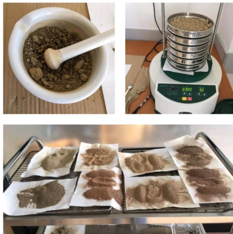
Figura 3. 3: Bluara e dheut në havan porcelani, sitimi deri në masë homogjene, mostrat e dheut pas sitimit.
