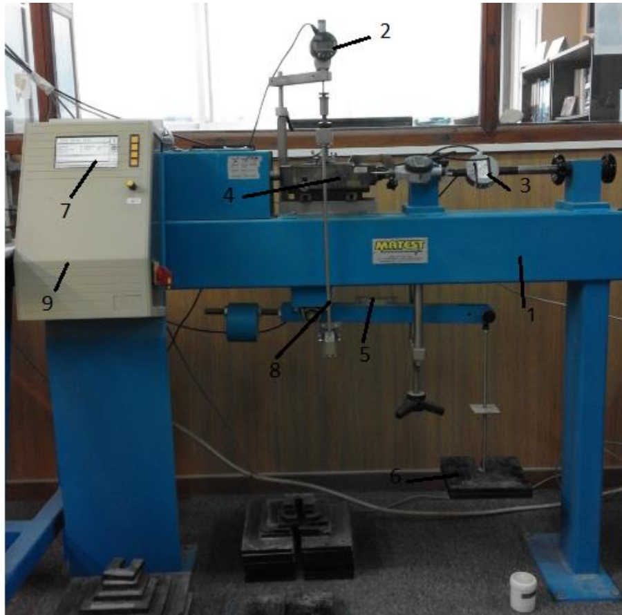
Figura 39. Pamje e aparaturës elektronike për kryerjen e provës me prerje direkte
