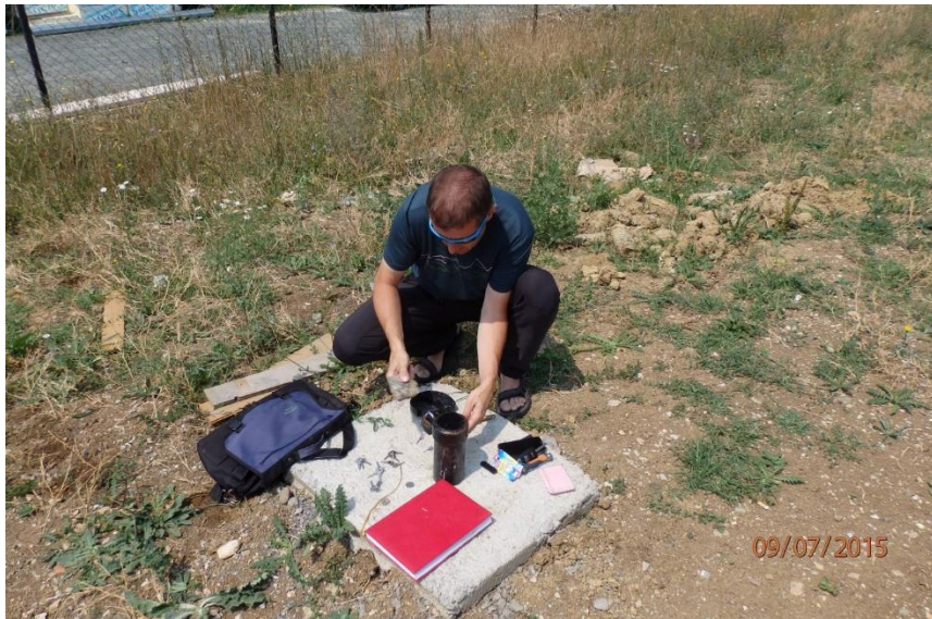
Figura 10. Instalimi i regjistruesit në Piezometer.
