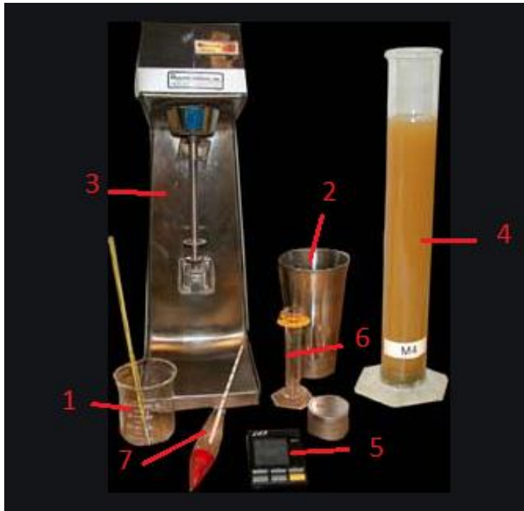
Foto 6. Pajisjet e nevojshme për kryerjen e provës me hidrometrim, (1-ena me mostër, 2-gota në të cilën hudhet mostra për përzierje, 3-përziersja, 4-menzura me moster, 5-kronometri për matjen e kohës, 6-menzura me \text{Na}_2\text{SiO}_3 , 7-aerometri.
