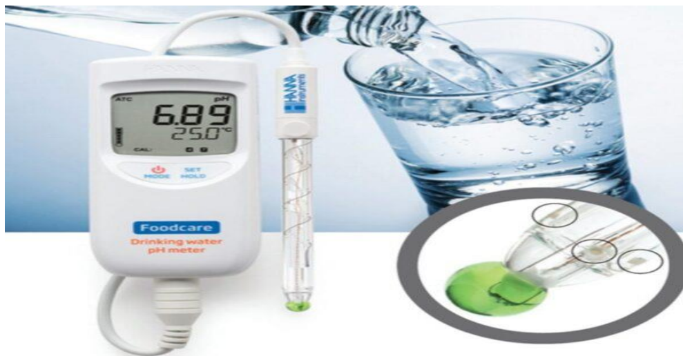
Figura 2.2: Instrumenti për matjen e pH në ujin e pijshëm.
