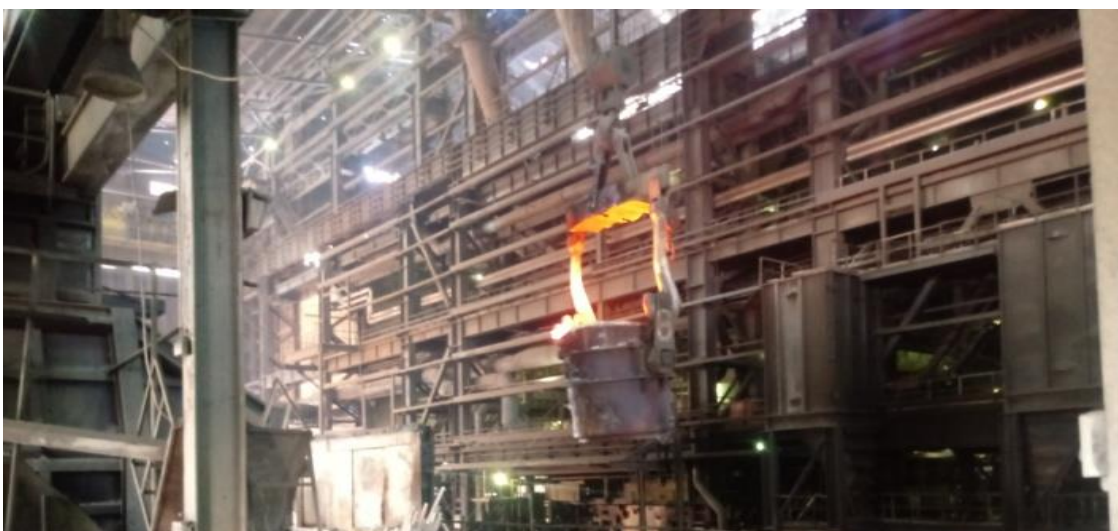
Figura 6: Mbushja e konvertorit me ferronikel lëndor/metal te furrës elektrike
